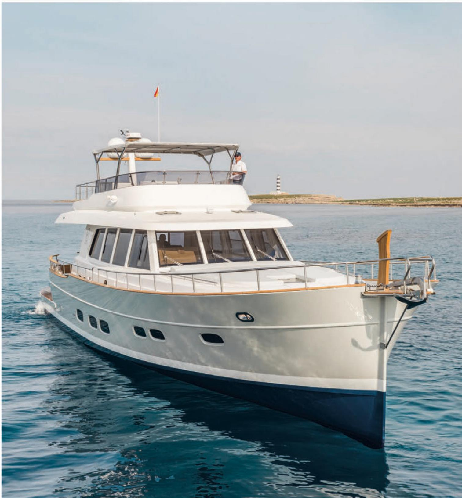
Eslora total: 21,240 m; Eslora casco: 18,00 m; Manga de casco: 5,80 m; Desplazamiento en rosca: 30 Tn; Calado: 1,60 m; Combustible: 3.350 L; Capacidad agua: 1.433 L
