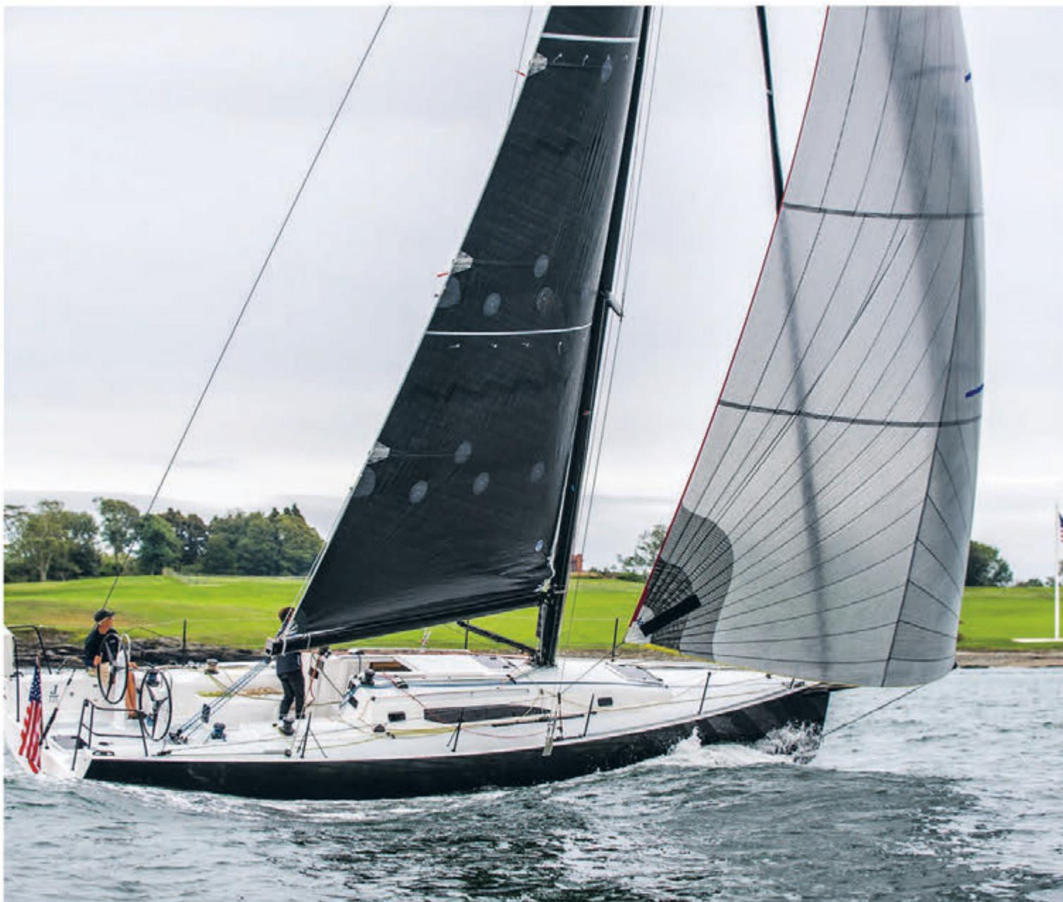
Eslora casco: 12,19 m; Eslora de flotación: 11,08 m; Manga: 3,75 m; Desplazamiento: 5.389 kg
