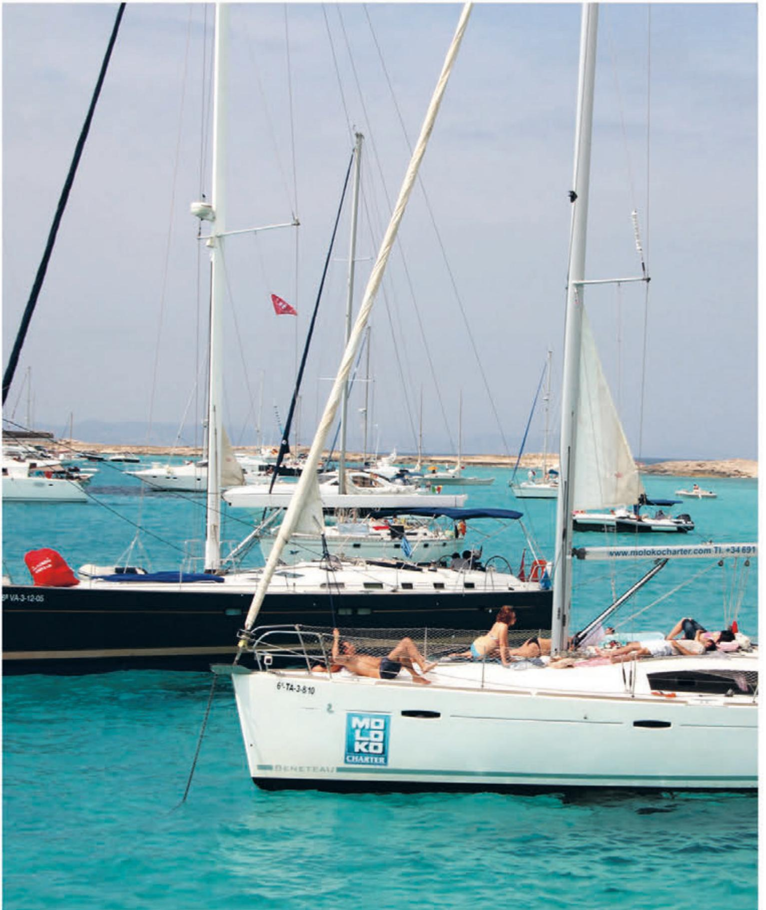
De este modo el ancla quedará firme. En condiciones normales la longitud de cadena suele ser de tres veces la sonda. Si va subiendo el viento o la mar, se darán más metros de cadena, como mínimo cinco veces la sonda. Una vez finalizada la maniobra se apagará el motor.
