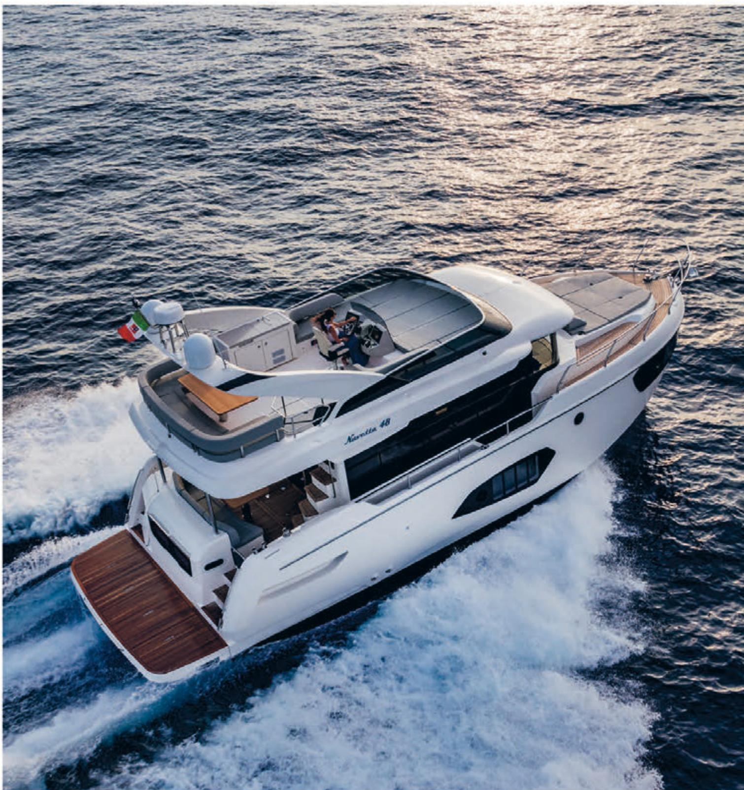
Eslora total: 14,93 m; Manga: 4,65 m; Agua dulce: 530 L; Combustible: 1.800 L; Calado carga completa: 1,25 m; Desplazamiento a carga completa: 23,5 t; Camas: 6+1
